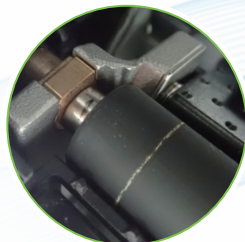
Biała linia zaczyna się ścierać w miarę postępującego zużycia wałka dociskowego.
